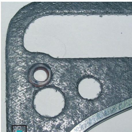
Окантовка масляного канала прокладки неизвестного производителя имеет гофры и вмятины
